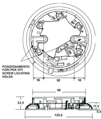
FIG. 1 Dimensioni fissaggio per Base Rilevatore
