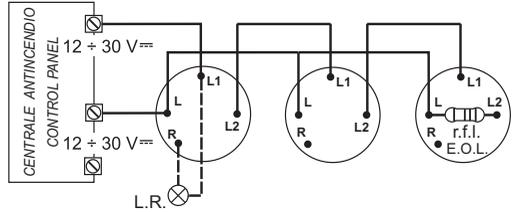
FIG. 8 Schema di Collegamento Semplicizzato con rilevatori serie 600
