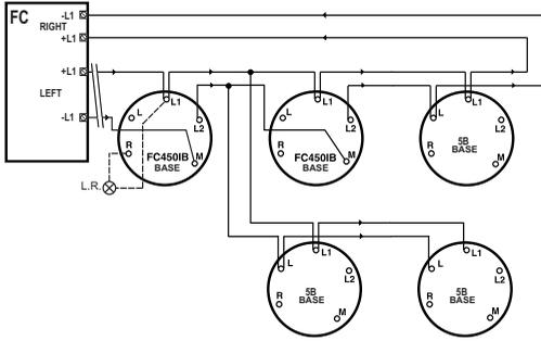
FIG. 7 Schema di Collegamento Semplicizzato con rilevatori serie FC400
